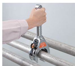
ラチェット機構とロータリーヘッドで狭い場所でも楽々作業
