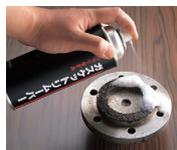
メンテナンスの際、焼付いたガスケットを効率的に処理できる剥離剤。
